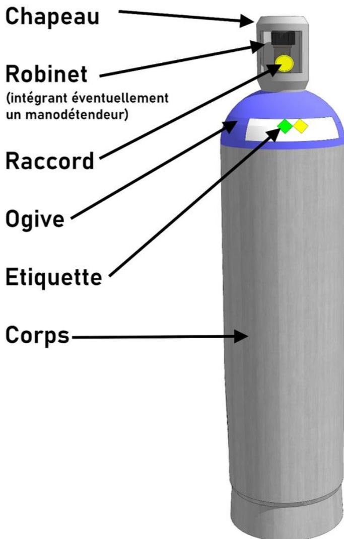
Les différents éléments composant une bouteille de gaz sont les suivants :
