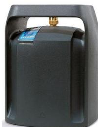
Exposée aux flammes, la bouteille « cube » démontre un comportement sécurisant pour les sapeurs-pompiers de par la dégradation intrinsèque des matériaux qui la composent et la rapidité du déclenchement de son fusible thermique.
