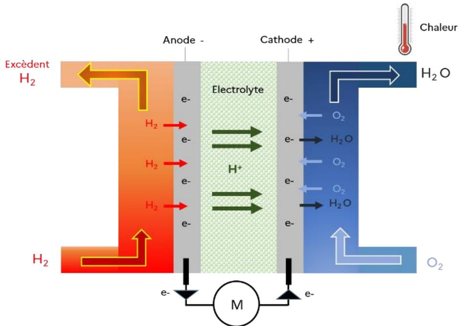
Principe de fonctionnement d'une pile à hydrogène
