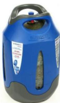
A l'inverse des bouteilles « traditionnelles », les bouteilles « composite » ne se dilatent que très faiblement (2 à 3 %). Soumise au feu, l'enveloppe de la bouteille devient poreuse au contact de la chaleur, le gaz fuit à travers et vient alimenter l'incendie.
