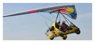
Un pendulaire est un aéronef monomoteur sustenté par une voilure souple sous laquelle est généralement accroché un chariot motorisé. Il répond aux conditions techniques suivantes :
