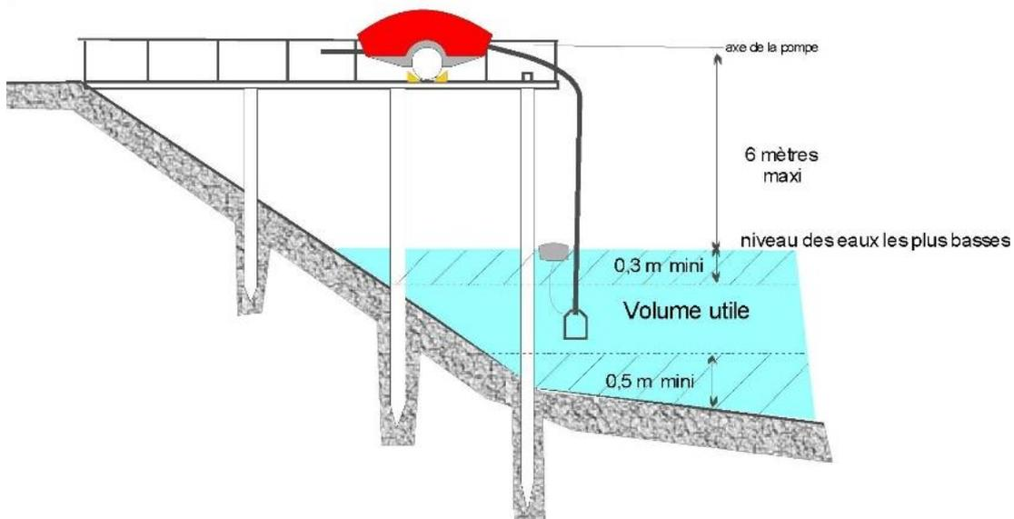
Illustration n°2 : Schéma de principe d'une estacade
