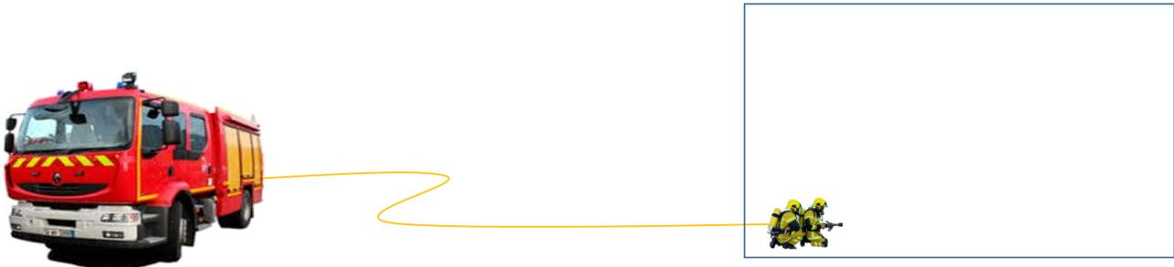
*Illustration n°1 : schéma de principe d'établissement d'une ligne d'attaque*
