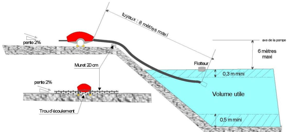
Illustration n°1 : Schéma de principe d'une aire d'aspiration
