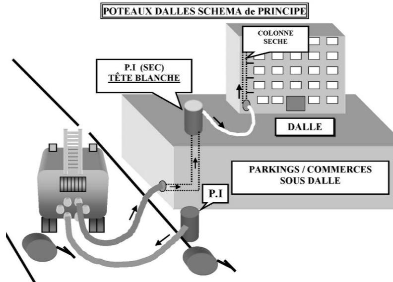
*Illustration n°15 : Principe de fonctionnement du poteau relais*
