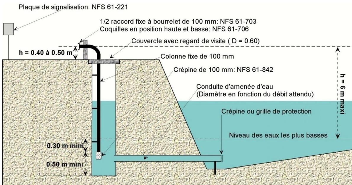
Illustration n°6: Schéma de principe d'un dispositif déporté d'aspiration
