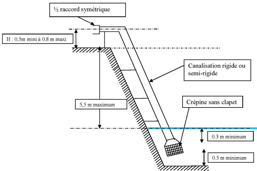
Illustration n°4 : Schéma de principe d'un dispositif fixe d'aspiration
