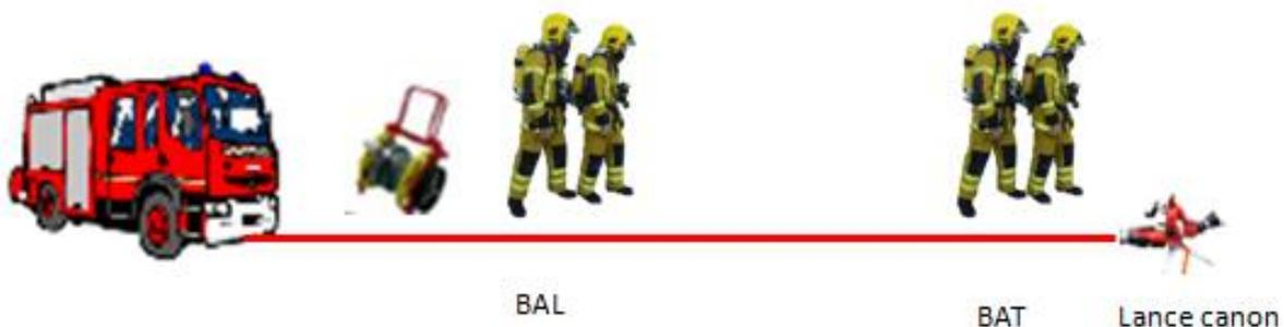
*Illustration n°1 : Schéma de principe d'établissement d'une lance canon*
