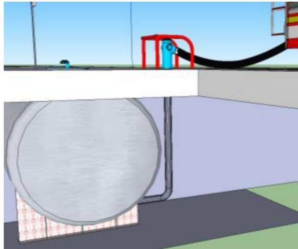
Illustration n°8: Dessin d'une réserve artificielle - réservoir enterré avec canalisation d'aspiration
