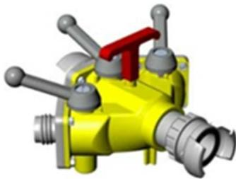
La division mixte FDF à clapet maintient en eau l'établissement de grande longueur sur les pentes positives en cas de rupture d'un tuyau en évitant la perte de la colonne d'eau se trouvant en amont de ce clapet, mais permet aussi un gain de temps appréciable lors du refoulement (une minute pour cent mètres environ).
