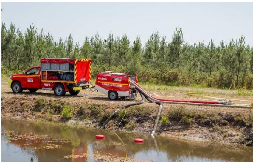
En complément des engins destinés à la lutte, des engins d'appui peuvent être utilisés lors de feux établis ou se développant dans des secteurs géographiques à faible ressource en eau pour assurer une alimentation continue des engins.
