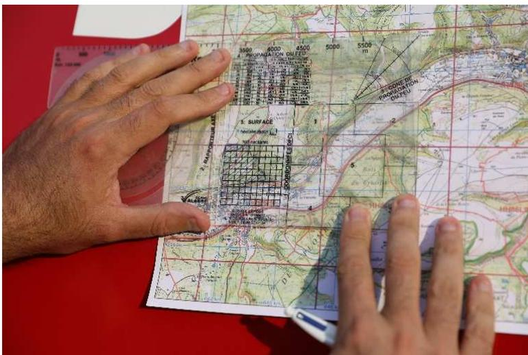
La réglette feux de forêts est un dispositif de traçage rapide de direction permettant de reporter sur une cartographie l'axe principal de propagation du sinistre. La présence des deux échelles (1/25000 et 1/100000) facilite grandement la projection de la vitesse de propagation théorique.
