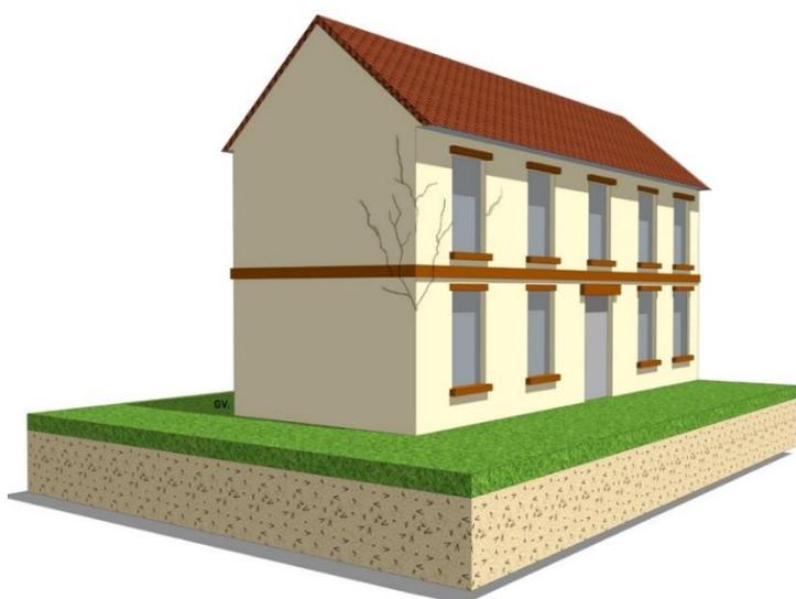
Des fissures aux coins augmentent de bas en haut signifiant qu'il y a des poussées horizontales à la tête des murs, qui tendent à faire s'ouvrir le bâtiment.
