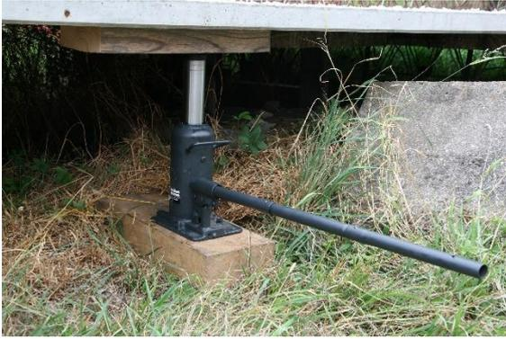
Elle est destinée à répartir une pression donnée sur une plus grande surface, ce qui a pour but d'éviter l'enfoncement d'une charge ou d'un matériel supportant une charge.
