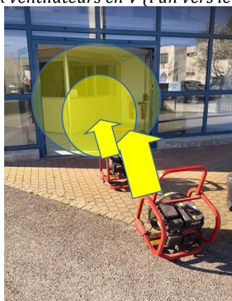
Illustration n°5 : Utilisation de deux ventilateurs l'un derrière l'autre
