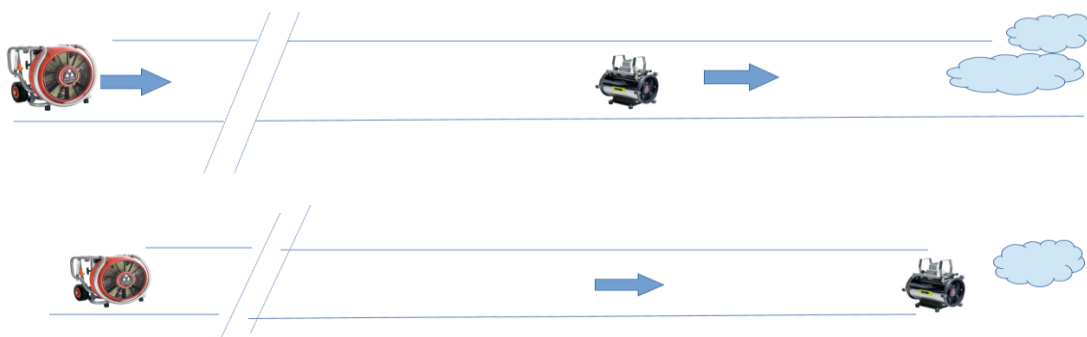
Illustration n°9 : Principe d'utilisation de ventilateurs à l'entrant et au sortant
