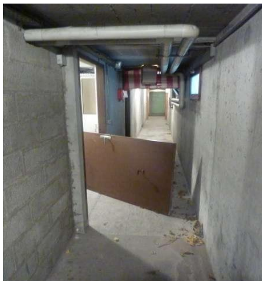
Illustration n°2 : Dans un couloir lui-même balayé par un flux d'air, la veine d'air est déviée en partie basse vers un petit local borgne au moyen d'une porte dégoncée placée en biais. Les fumées pourront ainsi s'échapper en partie haute
